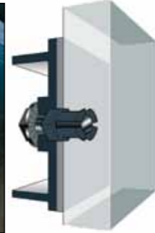
Links: Eine Besonderheit der Fassade ist die Hinterschnitt-Verankerung, für die es eine europäische technische Zulassung sea DIBt gibt
